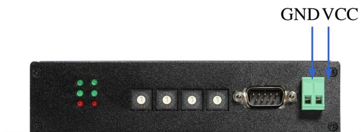
图 2.7 旋转拨码开关
